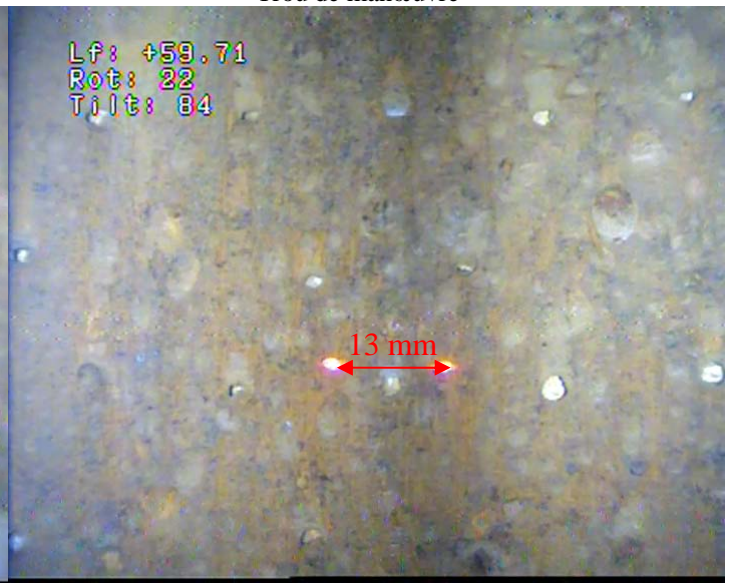
56 – Trous d'environ 2 à 3 mm de diamètre sur le tubage 500 mm
