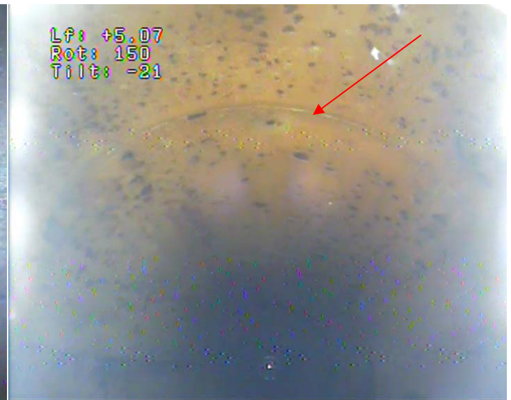
8 - Tubage acier en Ø 550 mm, soudure n°3
