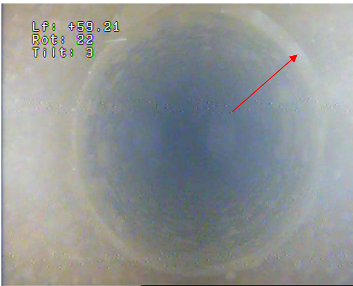
51 – Réduction tubage acier en Ø 500 / 450 mm
