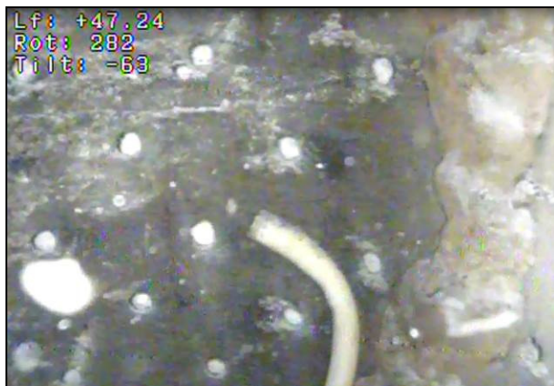
Photo 5 : Crépines et tube à 47,2 m
