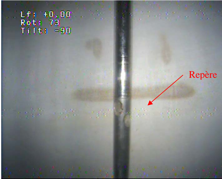
1 – Origine des mesures de profondeur – (53 cm sous le haut du tube inox, soit le dessus de la dalle béton)
