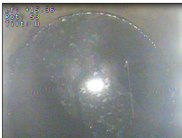
Photo 1 : Niveau statique à 15,87 m
