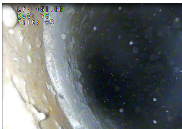
Photo 7 : Réduction tube acier en ø 500/450 mm
